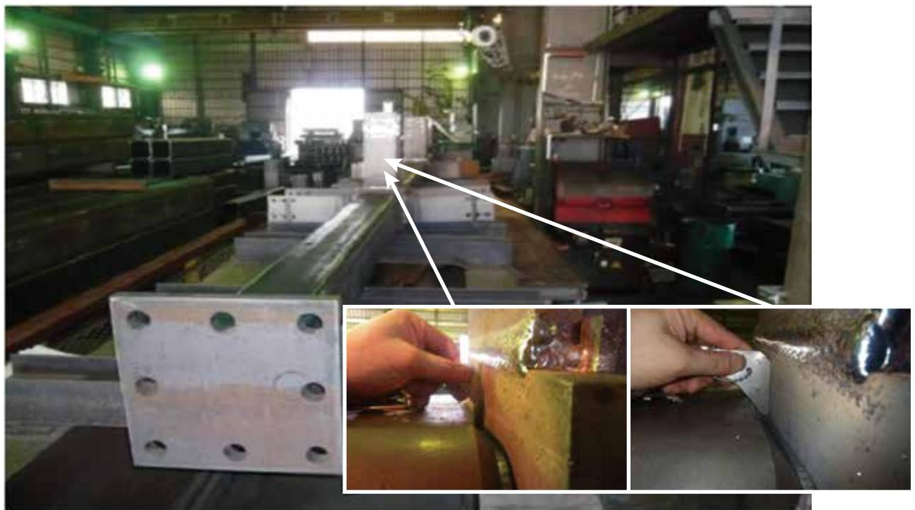
コア溶接が終わるとシャフトとコアを組立てる**大組作業**に移ります。加工図を確認しながらルート間隔7mmと開先角度35度をキープして柱の長さに組立てます。組立て後は溶接口ボットにて溶接しますが、自動溶接が不可であれば作業者が接合部の溶接を行ないます。
