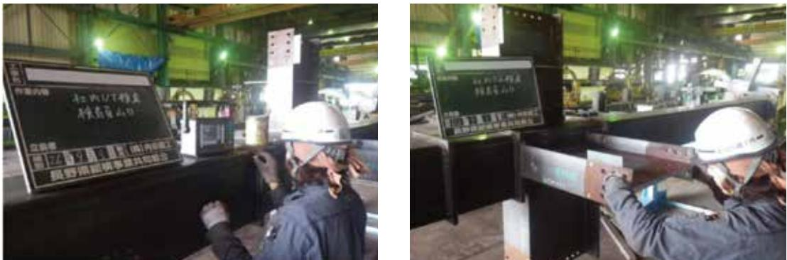
製品を仕上る前に社内検査を行ないます。完全溶け込み溶接部は超音波で溶接部の状態を検査します。もしも溶接内部に欠陥があれば欠陥の部分を取り除いて再溶接をします。
