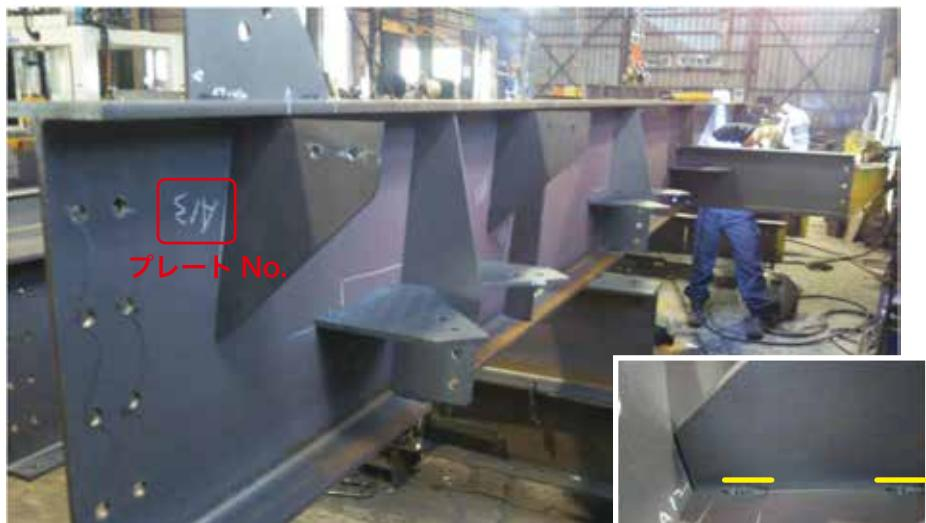
製品マークが付いた梁材と図面を確認してプレートの位置、番号を梁材に直接書くこの作業をケガキ作業と呼びます。ケガキ後は図面と同様にプレートを組み立てますが、溶接は組立て溶接になるので、全周溶接は行わず、溶接長さは40mm以上になる様に溶接を行ないます。
