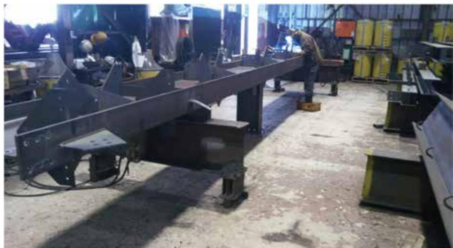
梁組立て作業後は溶接作業者が細かな所まで溶接作業を行ないます。溶接サイズと溶接外観が重要になる隅肉溶接を行ないます。
