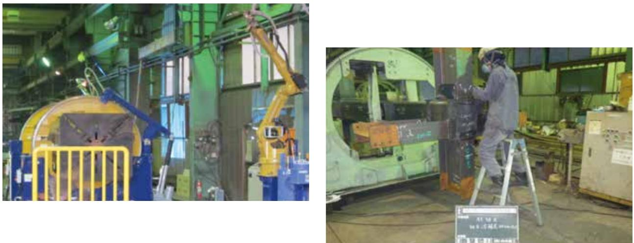
溶接口ボットは合計4台ありますが、ロボット溶接が対応出来ない場所は作業者が溶接をします。溶接継手の中で隅肉溶接を施す箇所はロボットに教示せるより、効率の良い作業者で行ないます。部品は大組口ボット溶接が終わった後に図面を確認しながら組み立てます。(二次部材の組立て)
