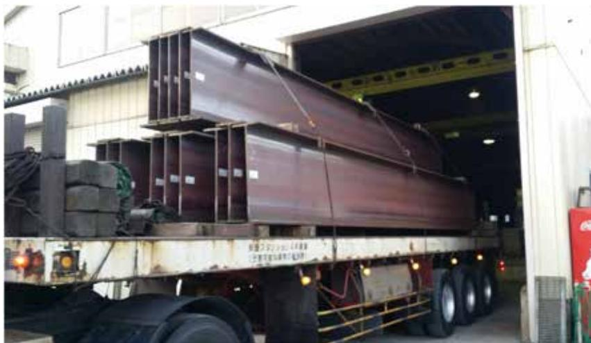
H型鋼は大型トラック（10t）かトレーラー（25t）で運ばれ第二工場に入荷します。柱、梁とプラケットに加工します。写真の材料のサイズはH-900×250×16×28で7mの長さで鋼材1台≈1526kgの重量になります。毎回同じ材料ではなく、工事ごと使用目的ごとに変わりますので必要な分だけ工場に運ばれています。
